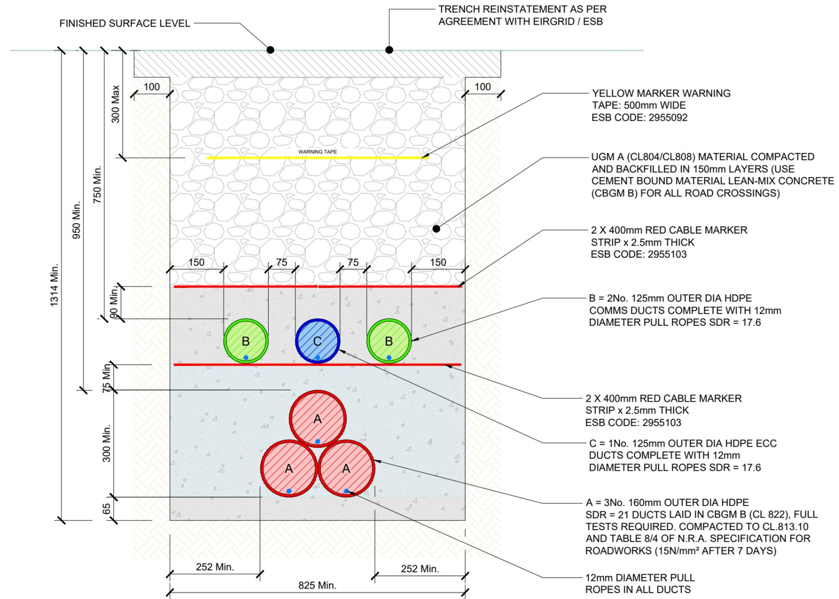
110KV CABLE TRENCH DETAIL
